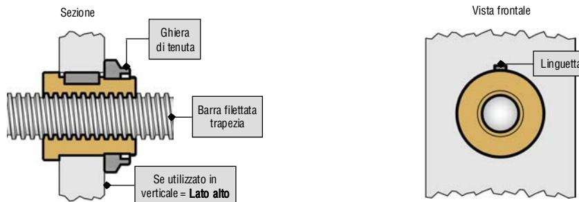
Per la lubrificazione suggeriamo un foro trasversale al supporto/chiocciola filettato alle estremità per l'inserimento di un ingassatore o di un raccordo.
