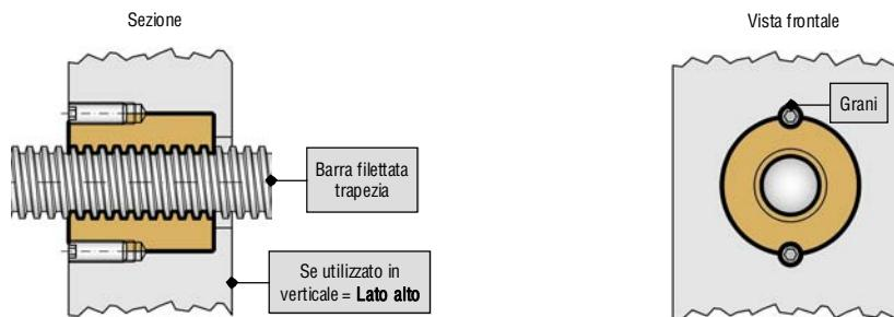
Per l'utilizzo delle chiocciola cilindriche dovete realizzare una sede nel vostro supporto in tolleranza **K6 (oppure H7)** calettare la chiocciola fissandola con i grani come da disegno. Per la scelta del diametro del grano da utilizzare consigliamo il seguente calcolo con approssimazione +/- 10% ed esattamente:
